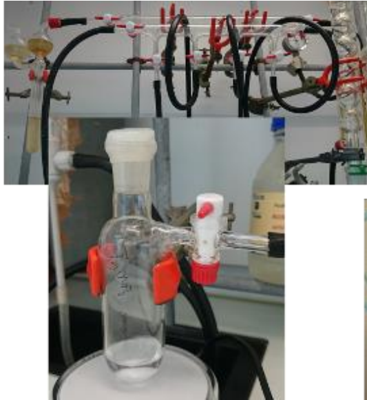
Synthèse sous atmosphère contrôlée. Technique de Schlenk Rampe à vide
